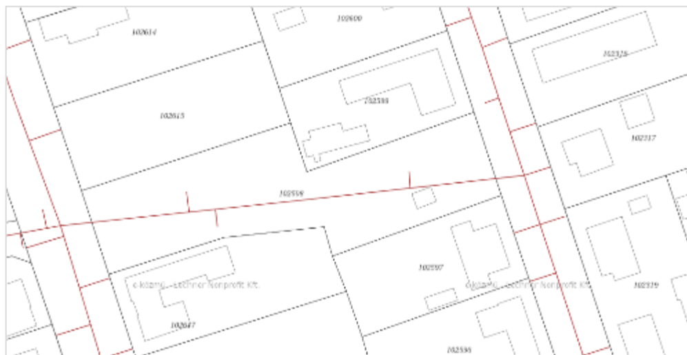
80 cm-es betoncsatorna tengelye
